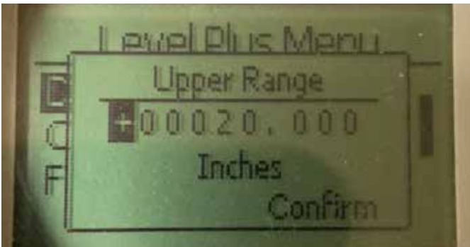
Fig. 44: Display "Prod URV (20 mA)"
