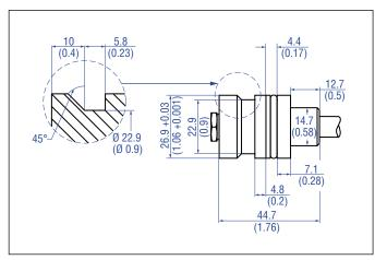
Fig. 44: Pressure fit flange »S« details
