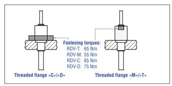
Fig. 40: Mounting example of threaded flange »C«/»D«, »M«/»T«
