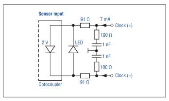
Fig. 26: Input wiring clock (+)/clock (-)
