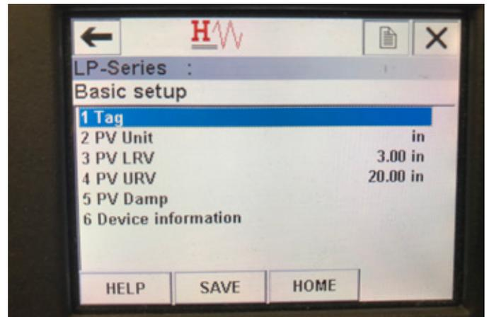
Fig. 23: Schermata del menu Basic setup (configurazione di base)
