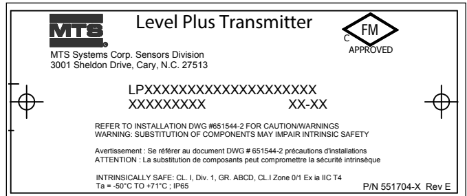
그림34: 본질 안전 FMC 라벨, HART®, 단일 및 듀얼 캐비티 하우징
