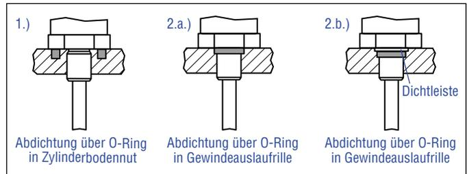
Abb. 10: Möglichkeiten der Abdichtung für Gewindeflansch mit flacher Flanschfläche
