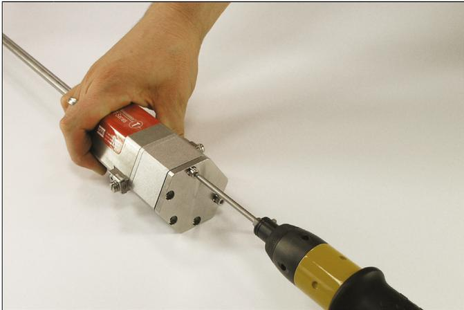
**1** Lösen Sie die fünf M4×10 Schrauben (SW 3). Entfernen Sie den Deckel. Lösen Sie anschließend die sechs M4×40 Schrauben (SW 3) des Anschlussadapters. Entfernen Sie den Anschlussadapter. Siehe auch Abb. 7.
