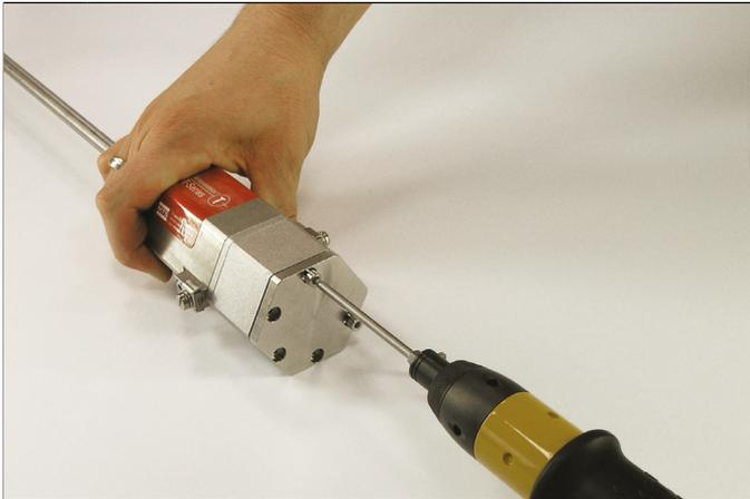
**1** Lösen Sie die fünf M4×10 Schrauben (SW 3). Entfernen Sie den Deckel. Lösen Sie anschließend die sechs M4×40 Schrauben (SW 3) des Anschlussadapters. Entfernen Sie den Anschlussadapter. Siehe auch Abb. 6.
