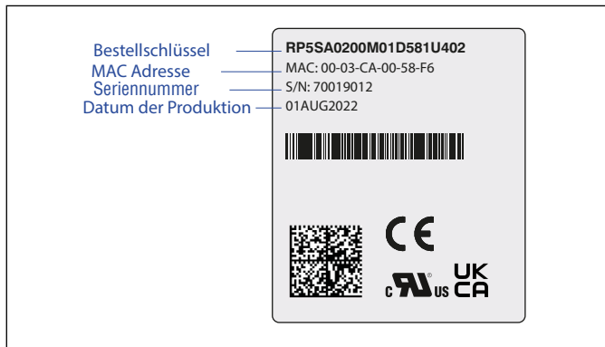
Abb. 1: Beispiel eines Typenschilds eines RP5-Sensors mit PROFINET-Ausgang
